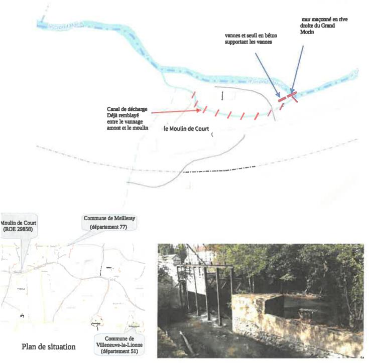
Photo des ouvrages (vannes et mur maçonné) du Moulin de Court
